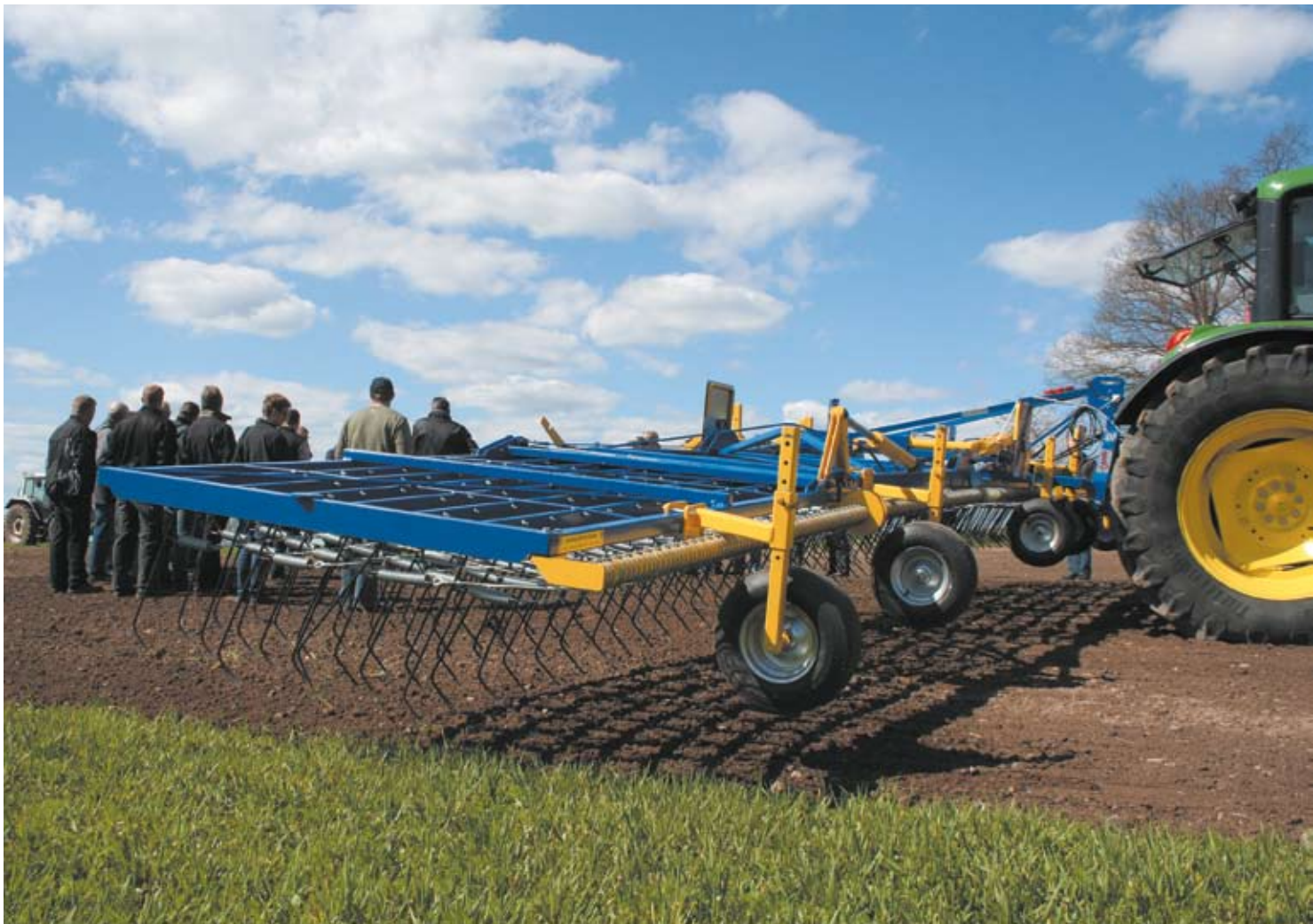
På Treffler-harven är pinnarna steglöst inställbara från 0,2–3 eller 5 kg via en central axel.
