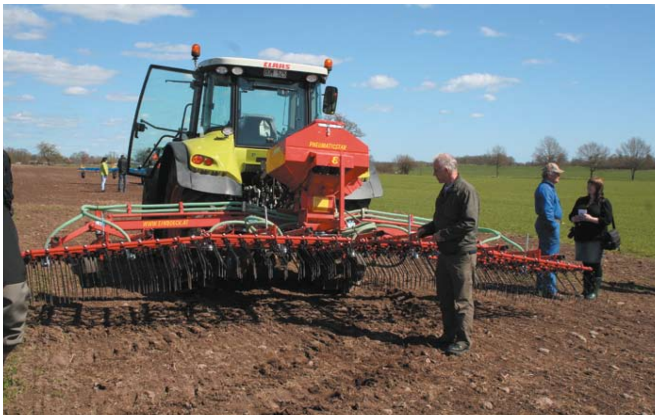
Einböck-harv med påbyggd pneumatisk såmaskin för vallinsådd.
