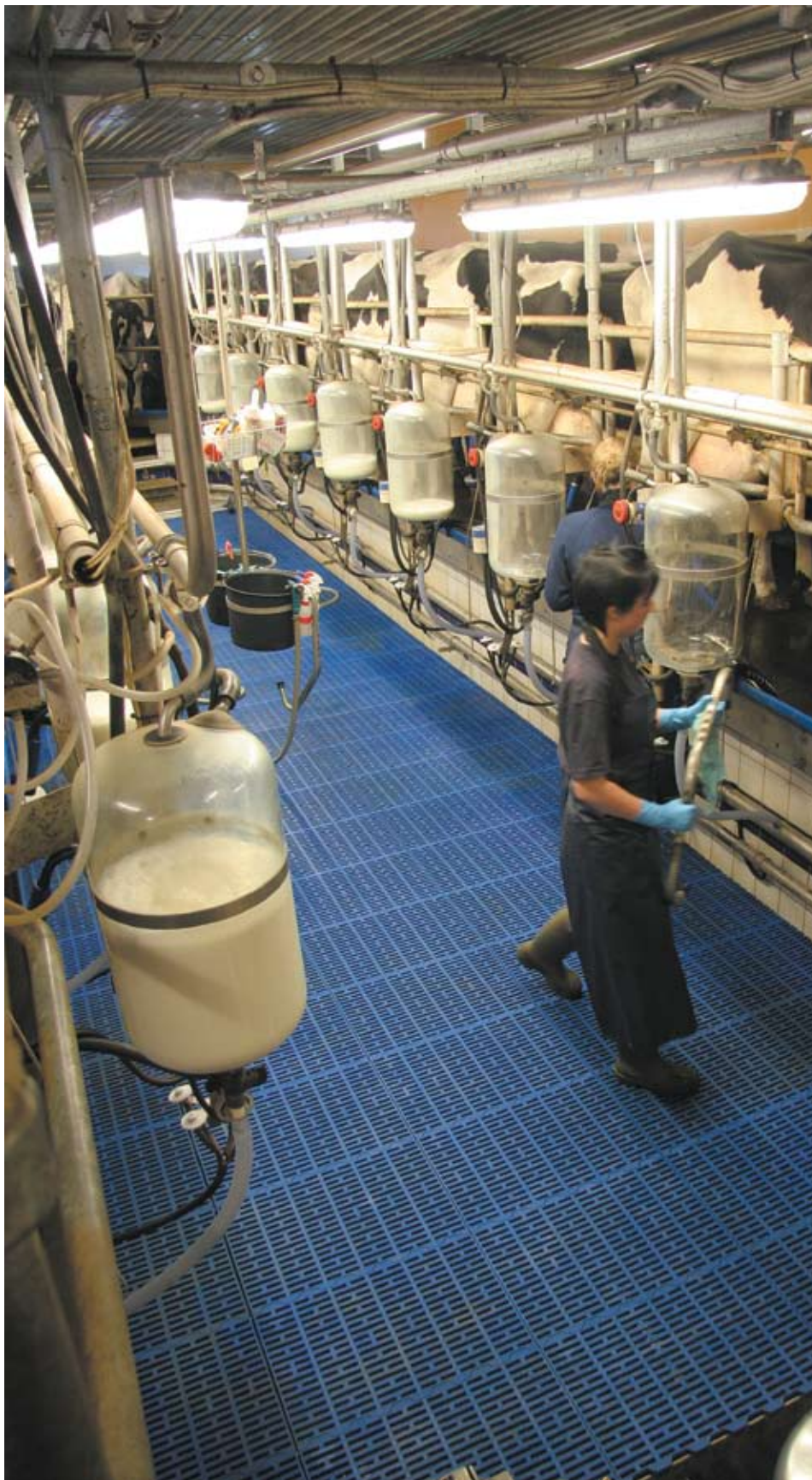
Rör och behållare i mjölkningsanläggningar är ett typiskt användningsområde för nanoteknologi. De kan förses med ytbeläggningar framtagna med nanoteknologi som förhindrar att bakterier kan fastna och växa till.
